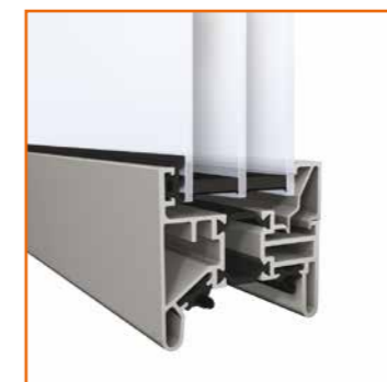
Panorama-Tor 60 mm Plexiglas-Dreifachscheiben Optical 40 mm (4-14,75-2,5-14,75-4 mm)
